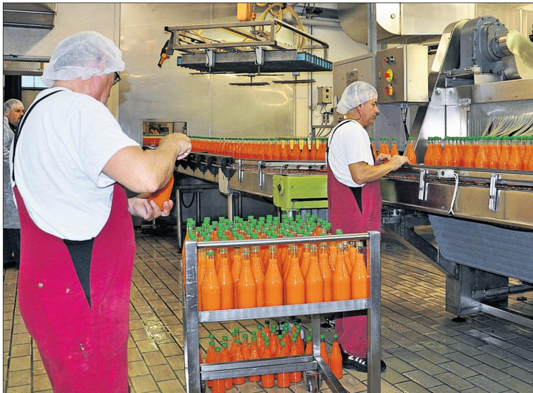
Bevor die abgefüllten Flaschen in die Etikettierung gehen, müssen Mitarbeiter kontrollieren, ob die Deckel richtig verschlossen sind.
