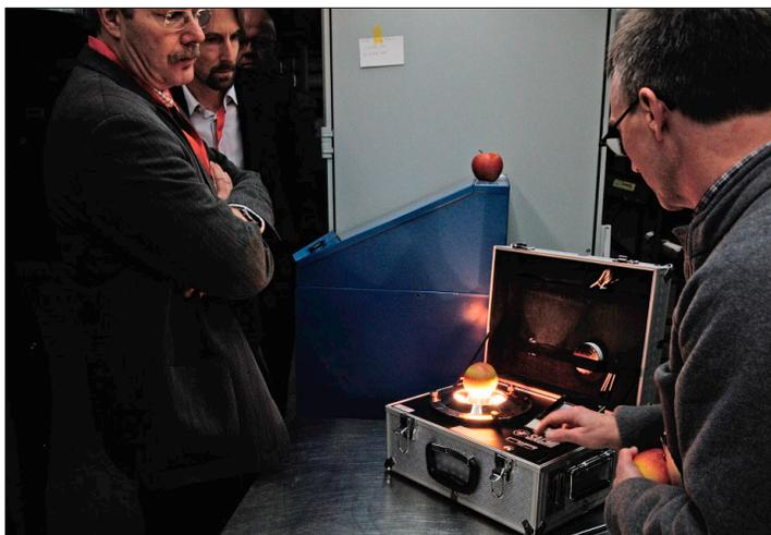
**Das Nah-Infrarot-Spektrometer untersucht einen Apfel, ohne ihn zu zerschneiden. (Bilder: Tobias Humm)**
